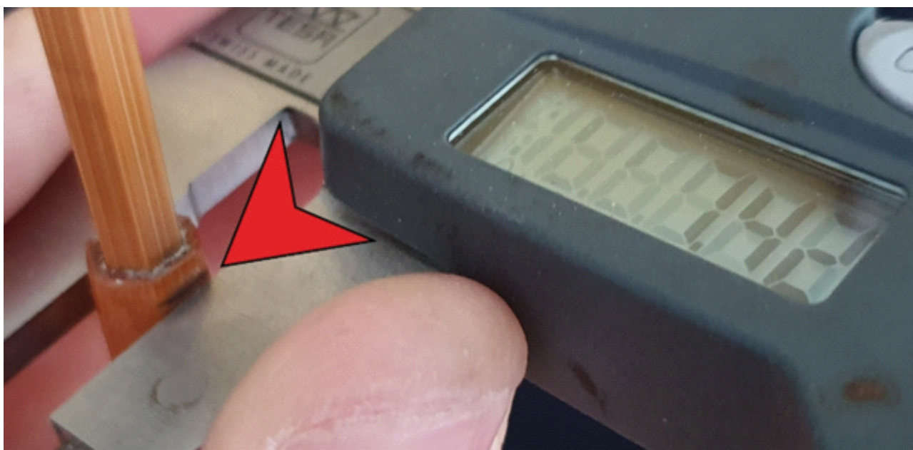
Punto sul bordo della femmina dove sono state eseguite le misure
