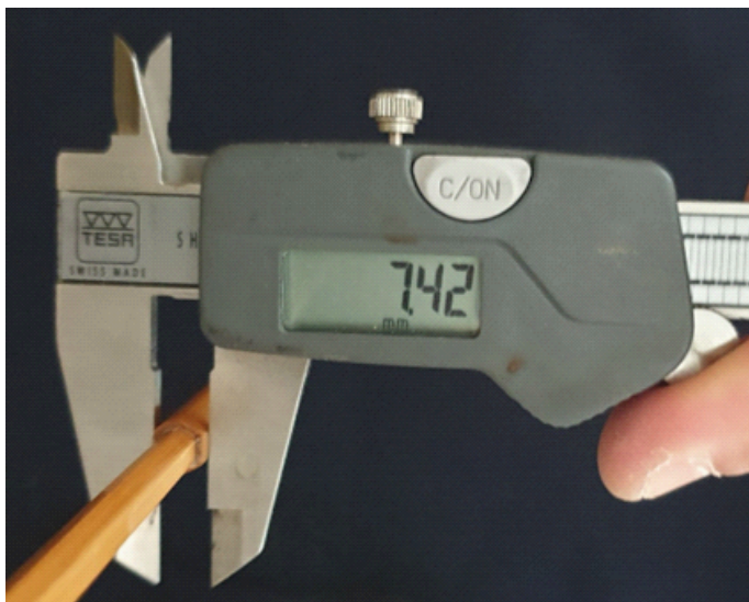
Misura larghezza femmina con maschio innestato
